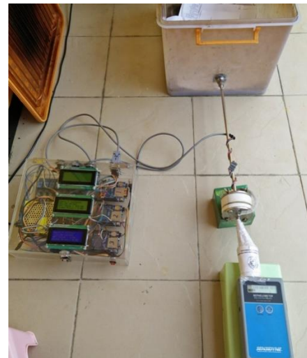
Gambar 9. Konstruksi kalibrasi SHARP GP2Y1010
