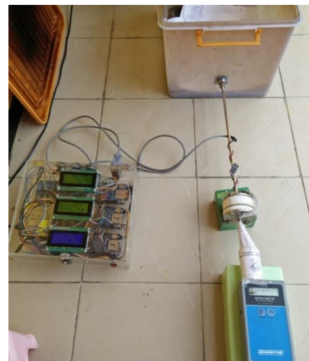
Gambar 9. Konstruksi kalibrasi SHARP GP2Y1010
